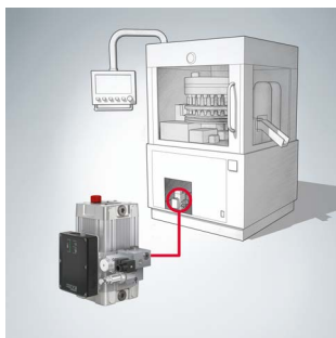
带 INKA 型紧凑泵站的加工机
