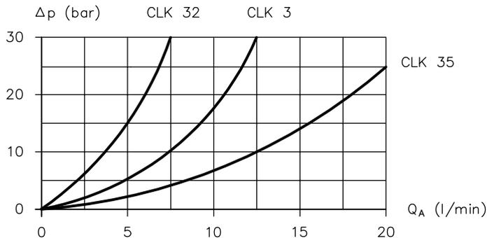
$Q_A$  caudal (l/min);  $\Delta p$  resistencia de flujo (bar)
