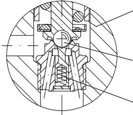
Un tope final de carrera evita la excesiva extracción de la bola de válvula en caso de descarga del muelle completo o en caso de caudal excesivo para la válvula así como el bloqueo de los orificios de paso por el pistón amortiguador.
