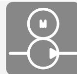
Groupe compact immergé à moteur électrique intégré (modèle à courant alternatif ou triphasé) et pompe monodébit.
