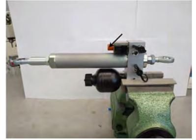
5. Kolbenstange (2) durch Auslösen der Notbetätigung (1) vollständig ausfahren.
