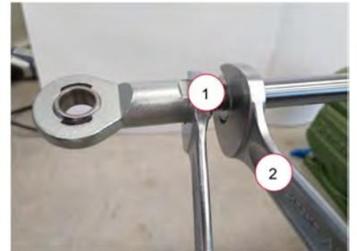
8. Gelenkkopf von der Kolbenstange abschrauben, so dass die Mutter auf der Kolbenstange bleibt.
