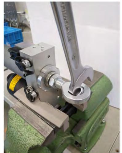
6. Das Innengewinde des Zylinderfußes mit dem Gewindebohrer von Kleberesten und Verunreinigungen reinigen.
