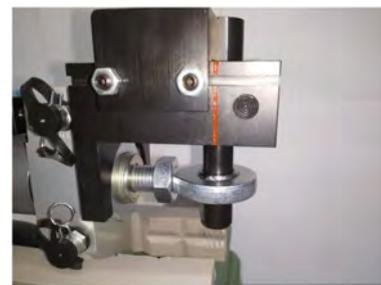
12. Auf das Gewinde des Gelenkkopfes Schraubensicherungsklebstoff auftragen.
