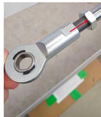
12. Gelenkkopf mit Gabelschlüssel (2) und Drehmomentschlüssel (1) bis zum geforderten Drehmoment gemäß der technischen Zeichnung anziehen.
