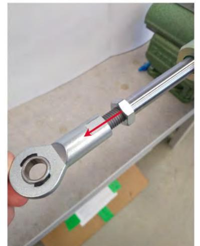
9. Gewinde mit einer Messingbürste bis zur Mutter reinigen und entfetten.
