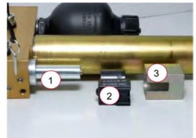
9. Montagehilfe (1) auf das Magnetgehäuse (2) setzen und Magnetgehäuse vorsichtig fixieren durch leichte Schläge mit dem Kunststoffhammer auf die Montagehilfe.
