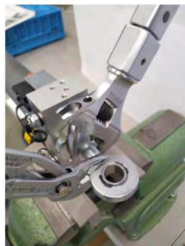
14. Mutter und Gelenkauge mit Schraubensicherungslack markieren.
