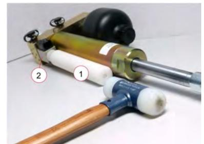
10. Prüfen, ob der Spalt zwischen Anschlussblock (1) und Magnetgehäuse (2) 0,5 bis 1 mm breit und umlaufend gleich ist.
