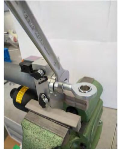
5. Gelenkkopf mit Gabelschlüssel vom Zylinderfuß runterdrehen.
