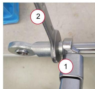
13. Nach dem Drehmomentanzug Mutter und Gelenkauge mit Schraubensicherungslack markieren.
