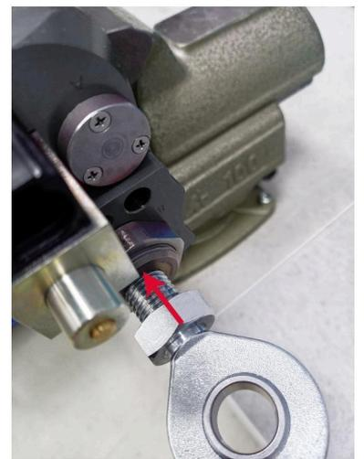
11. Auf das Gewinde des Gelenkkopfes Schraubensicherungs-
