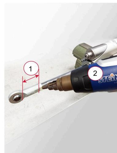
7. Erwärmt Gelenkkopf mithilfe der Gabelschlüssel öffnen.
