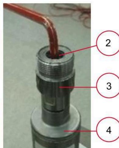
4. HAWE Befüllvorrichtung DFM 400 auf den Adapter schrauben.
