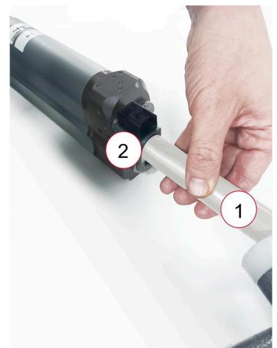
10. Prüfen, ob der Spalt zwischen Anschlussblock (1) und Magnetgehäuse (2) 0,5 bis 1 mm breit und umlaufend gleich ist.
