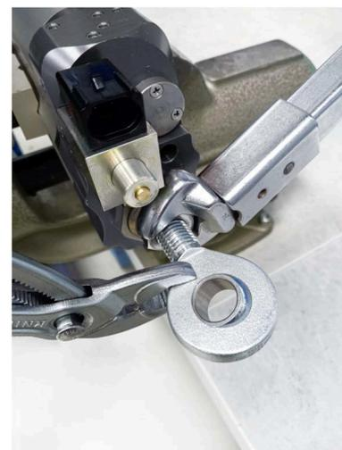
13. Mutter und Gelenkauge mit Schraubensicherungslack markieren.
