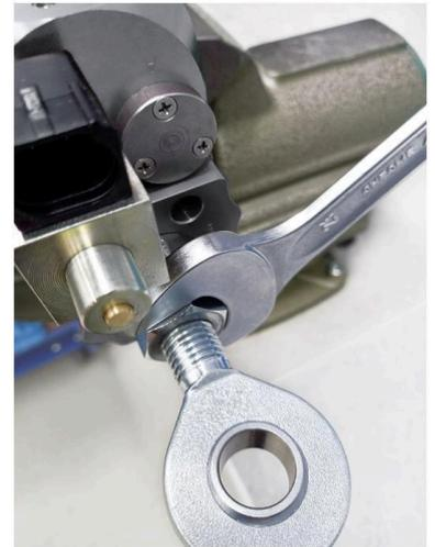
5. Gelenkkopf mit Gabelschlüssel vom Zylinderfuß runterdrehen.
