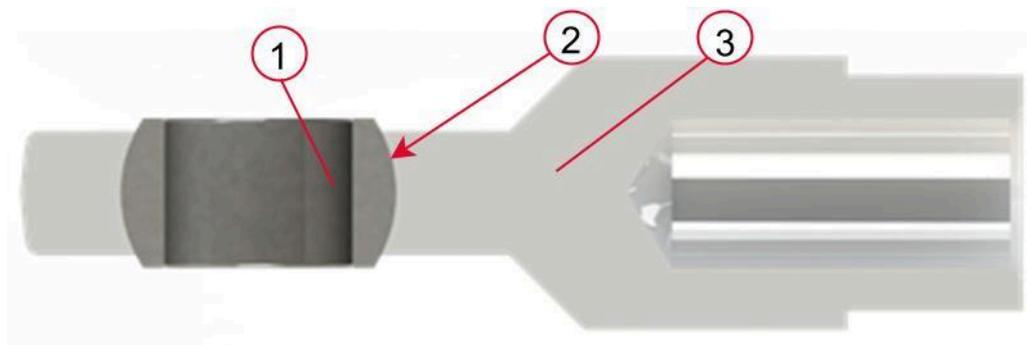
1. Die Gelenkkugeln (1) des hydraulischen Verriegelungssystems müssen frei zugänglich sein.
