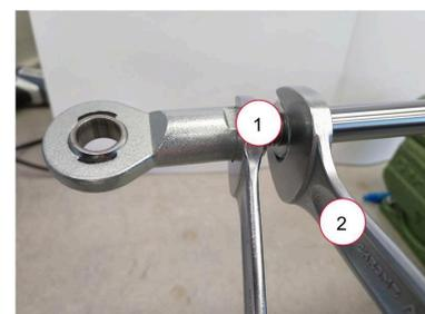
8. Gelenkkopf von der Kolbenstange abschrauben, so dass die Mutter auf der Kolbenstange bleibt.
