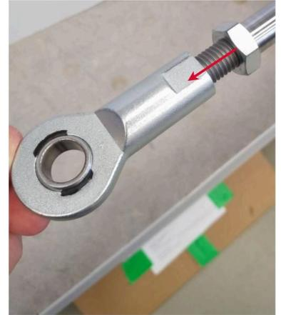
9. Gewinde mit einer Messingbürste bis zur Mutter reinigen und entfetten.
