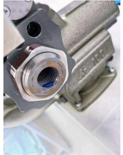
10. Gelenkkopf mit Mutter in das Gewinde des Zylinderfußes drehen.
