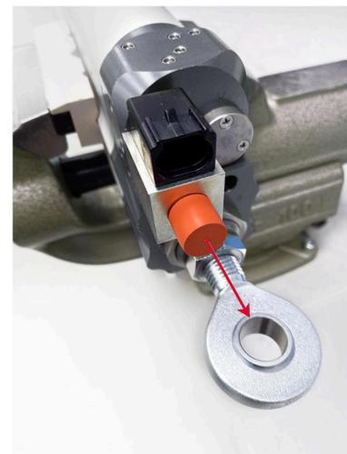
5. Kolbenstange (2) durch Auslösen der Notbetätigung (1) vollständig ausfahren.
