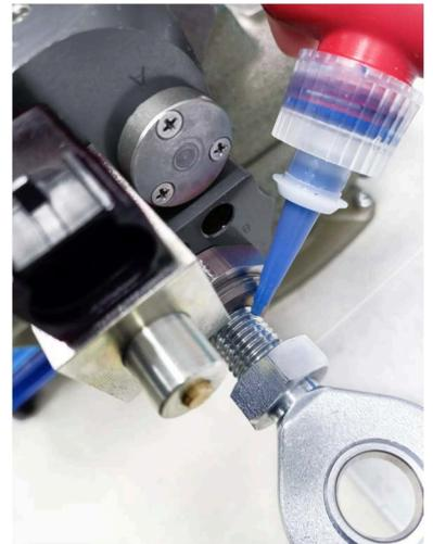
12. Die Mutter mit Drehmomentschlüssel (SW 24) bis auf Anschlag mit dem erforderlichen Drehmoment gemäß der technischen Zeichnung anziehen.
