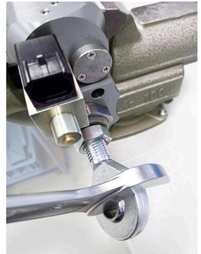
6. Das Innengewinde des Zylinderfußes mit dem Gewindebohrer (M 16) von Kleberesten und Verunreinigungen vorsichtig reinigen.
