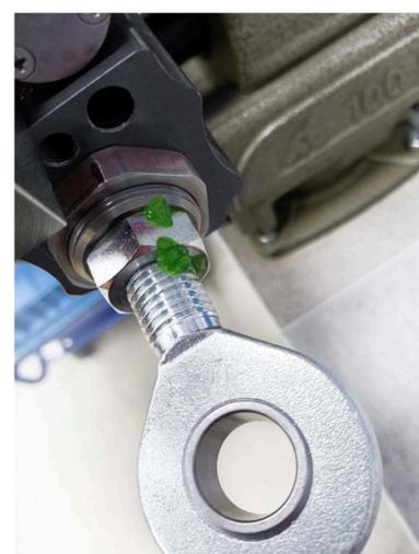
14. Nach 24 Stunden Aushärtungszeit kann das hydraulische Verriegelungssystem wieder verwendet und in der Anlage wieder in Betrieb genommen werden (siehe "Inbetriebnahme", Seite 29).
